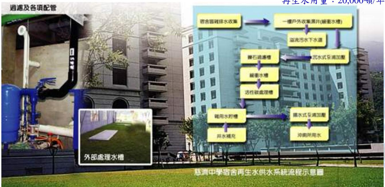
再生水處理程序：洗澡排水→雜排水濕井→砂濾系統→緩衝槽→活性碳過濾→再生水槽
